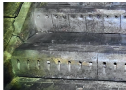
Detailvergleich FLL unten – konventionell oben nach 8000 h Betrieb
